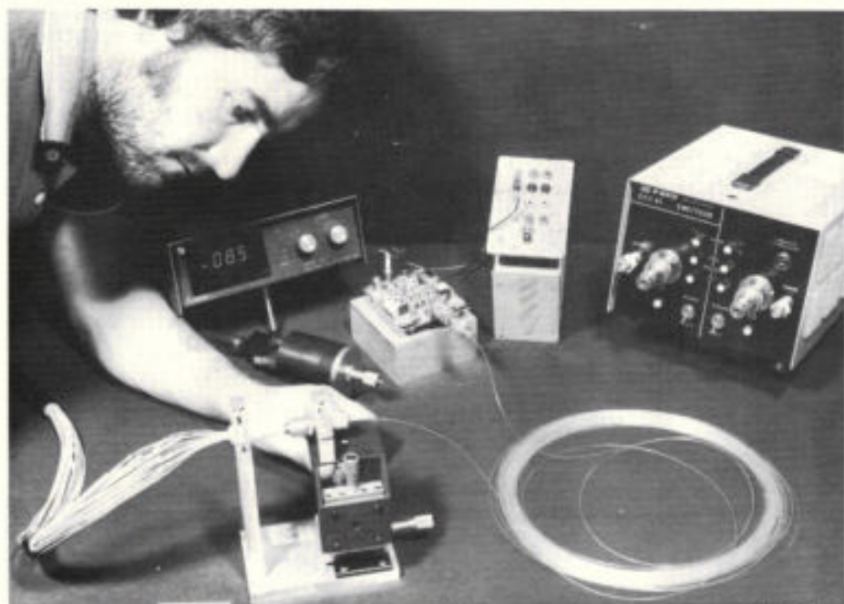
Afb. 3. Opstelling voor het meten van de demping in lichtgolfgeleiders in het CNET-centrum Lannion B.
